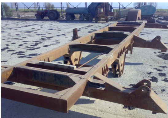
شکل ۴: شاسی اصلاح شده به همراه ورق
