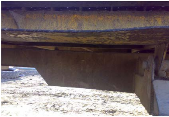
شکل ۳: ورق ۶۰ سانتی متری اضافه شده به شاسی
