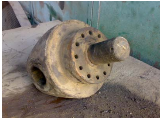
شکل ۱: کله گاوی با پیچ بعد از اصلاح
