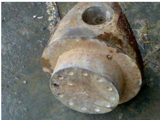
شکل ۲: کله گاوی بدون پیچ قبل از اصلاح
